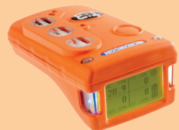
Das mobile Gaswarngerät Tetra 3.
