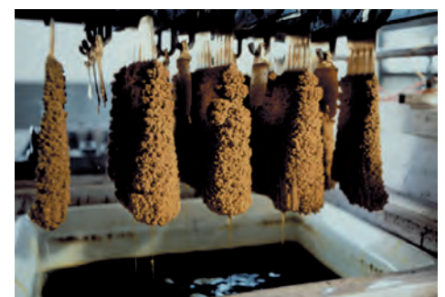
■ Gold lagert sich während des Elektrolyseprozesses an der Kathode ab.
